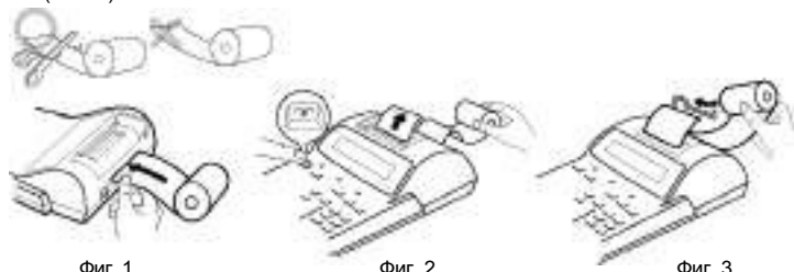
Фиг. 1 Фиг. 2 Фиг. 3 НЕ ДЪРПАЙТЕ ХАРТИЯТА В ОБРАТНА ПОСОКА; ПЕЧАТНИЯТ МЕХАНИЗЪЧ МОЖЕ ДА СЕ ПОВРЕДИ.
